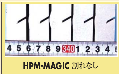
図 Y形溶接割れ試験片断面カラーチェック
