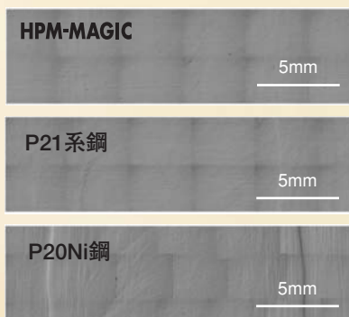
図 溶接後の磨き面の微分干渉像比較
