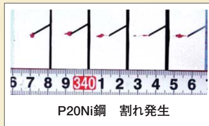
図 Y形溶接割れ試験片断面カラーチェック
