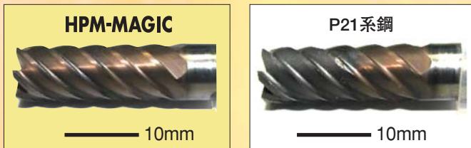
図 コーティング超硬エンドミルの高負荷条件での工具損傷比較例
